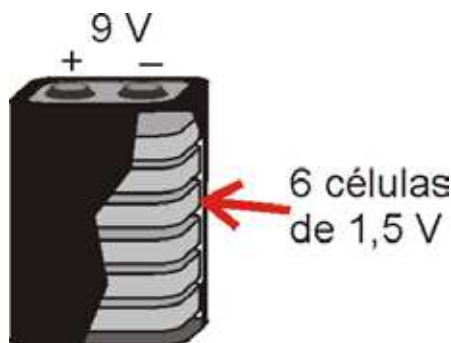
Figura 82 – 6 células de 1,5 V formam uma bateria de 9 V
