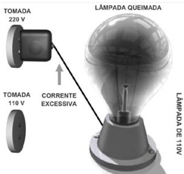
Figura 38 – Excesso de corrente queimando uma lâmpada
