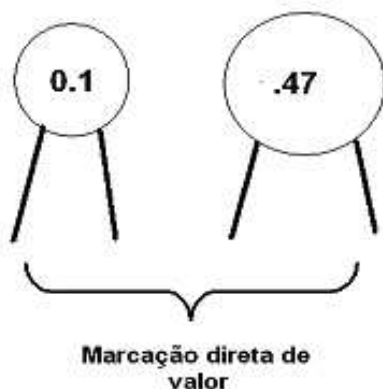
Figura 116 – marcação direta de valores – 0,1 \mu\text{F} ou 100 nF e .47 \mu\text{F} ou 470 nF
