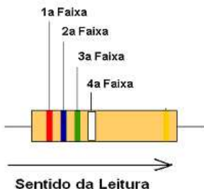
Figura 50 – Como ler um resistor.
