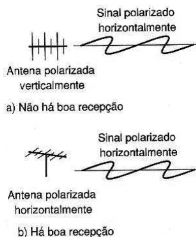
Figura 264 – A antena deve ser polarizada de acordo com o sinal que deve ser recebido
