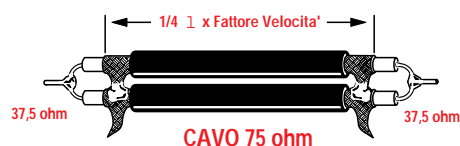
Fig.3 Per utilizzare un cavo di discesa da 52 ohm , dovete collegare tra i due dipoli e il cavo di discesa, un trasformatore elevatore d'impedenza che si ottiene collegando in parallelo due spezzoni di cavo coassiale da 75 ohm lunghi 1/4λ .
