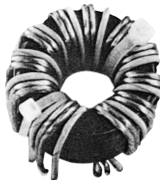
Fig.16 Sui nuclei toroidali il numero delle spire può variare se varia la "miscela" della ferrite. Per questo motivo conviene inizialmente avvolgere 10 spire anziché 7 e poi controllare con un Rosmetro se togliendo 1-2-3 spire, le onde stazionarie aumentano oppure diminuiscono.
