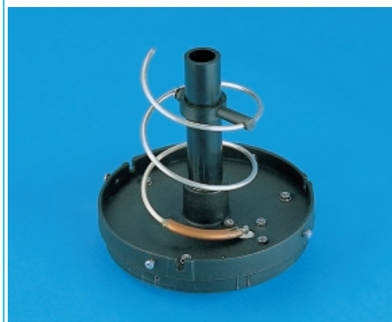
Fig.11 In queste due foto è visibile un adattatore d'impedenza ottenuto con un lamierino e un tubetto di rame lungo \frac{1}{4}\lambda applicato sulla prima spira.
