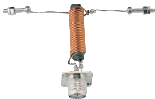
Fig.9 Foto di un trasformatore da bilanciatore a sbilanciato avvolto su un nucleo cilindrico in ferrocube.
